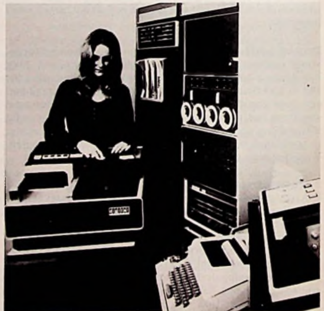
Het DECcomm 11D21 IBM-compatible remote job entry systeem kan bestaan uit een PDP-11/20 minicomputer met een 8K geheugen, magneetband eenheid, schijfengeheugen, ASR 33 teletype, zeer snelle ponsband lezer en ponsers, regeldrukker, en kaartlezer. De DECcomm 11D21 wordt geleverd met een volledig pakket COMTEX 11 programmatuur.
